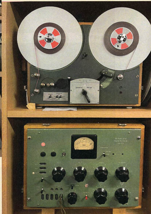
Erstes Studer Tonbandgerät 27A für Live-Aufnahmen beim Radio DRS
