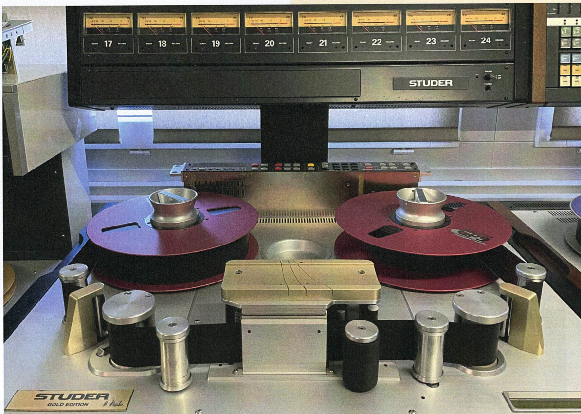
Studer A827 Gold - letzte analoge 24 Kanal Bandmaschine
