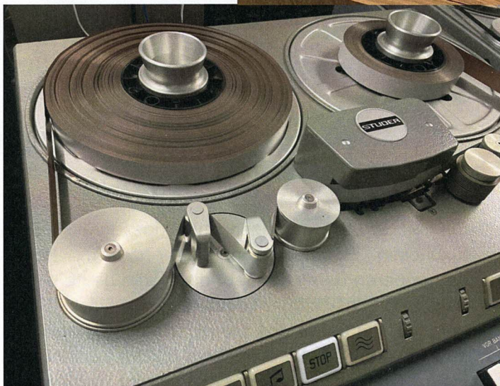
Studer J37 Vierspur-Bandmaschine, wie sie die Beatles in den Abbey Road Studios verwendeten
